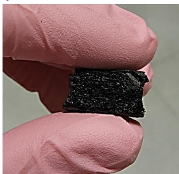
Piana grafenowa – widok makroskopowy (z lewej) i jej mikrostruktura (z prawej)
